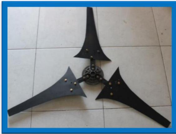
Gambar 8. Turbin Angin Material Arkrilik Setelah Selesai Dirancang, Dibuat dan Dirakit
