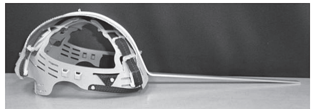
図5 装置（ヘルメットの頂点から水平に引いた線と平行になるように鉄製の棒をビスで止めたもの）
