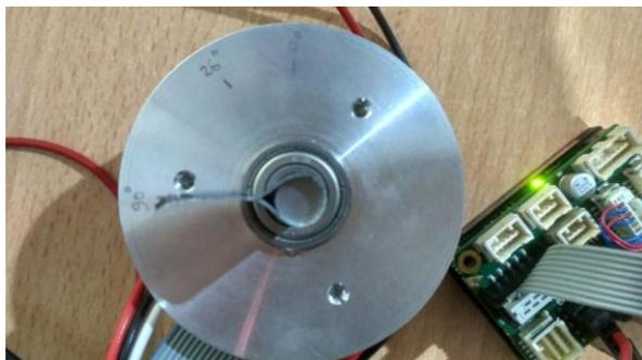
Gambar. 5. Tampilan posisi rotor BLDC dengan sudut 90°
