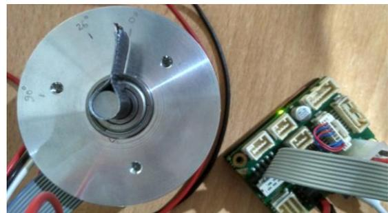
Gambar. 3. Tampilan posisi rotor BLDC dengan sudut 0°
