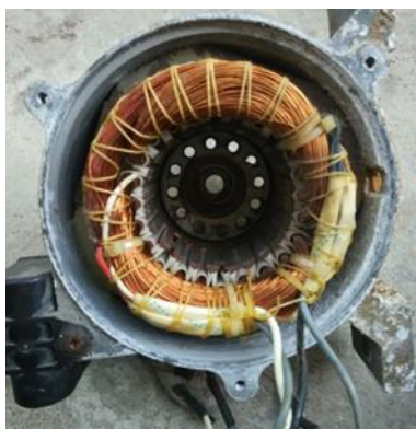
Gambar 3. Cuplikan hasil rewinding motor PH 100 ANB
