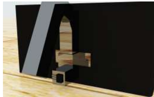
Gambar 6 : Peletakan Hall effect Sensor.
