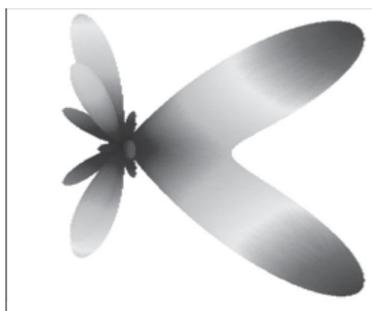
**Figura 7** Diagrama 3D Arreglo plano 5X5 dipolos
