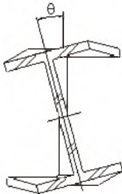
Figura 2. Esquema ilustrativo de una sección I solicitada a torsión
