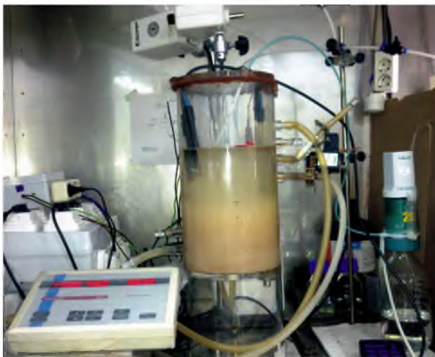
Figura 1. Esquema y fotografía del montaje experimental del reactor SBR.
