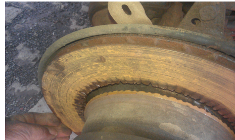
... die Bremsscheibe ist gebrochen
