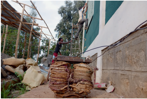
Auch bei den Werkzeugen, hier ein Schweißgerät, wird improvisiert
