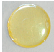
Abb. 14: hydrophiler Linsenrohling zur Fertigung einer IOL
