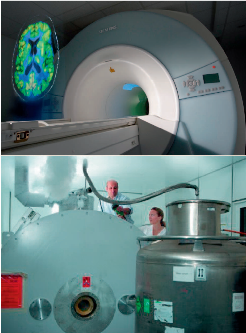
Abb. 2: Oben: 3-Tesla-MRT/PET-Hybridsystem für molekulare und funktionelle Untersuchungen am Gehirn des Menschen. Unten: 9,4-T-MRT für Untersuchungen im Tiermodell. Schon jetzt werden an diesem Gerät neue Methoden entwickelt, um pathologische Veränderungen im lebenden Gehirn mit höchster räumlicher Auflösung analysieren zu können.
