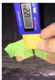
写真5 炭化深さ計測の様子
