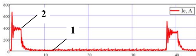
Рисунок 2. Струм якоря при двох проходах прокатки реального прокатного стану
