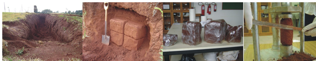
Figura 1. Abertura da trincheira, amostragem, acondicionamento e moldagem dos corpos de prova, respectivamente.
