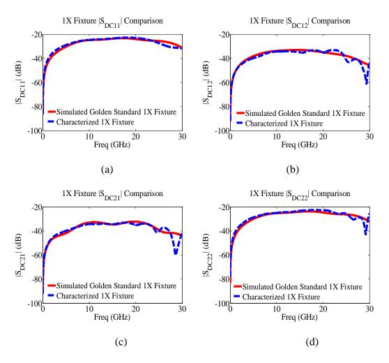
Figure 8. 1X fixture comparison: (a) |SDC11|; (b) |SDC12|; (c) |SDC21|; (d) |SDC22|;(e) |SDD11|;(f) |SDD21|;(g) |SDD22|.
