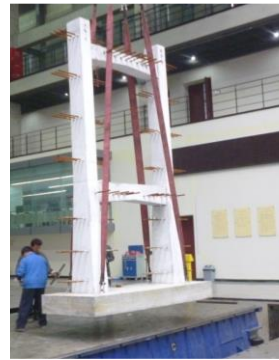
(d) Tower placement on shake table
