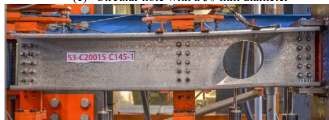
(d) Circular hole with a 145 mm diameter
