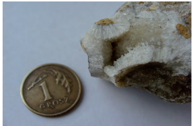
Fig. 15. Residual conglomerate with characteristic calcite binder, phot. A. Ziobro • Zlepieniec rezydualny z widocznym charakterystycznym spoiwem kalcytowym, fot. A. Ziobro
