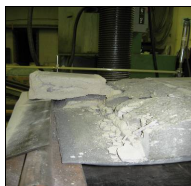
(d) Wall Failure
