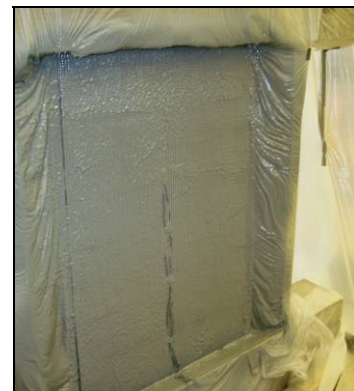
(d) GFRP-Polyurea Retrofit
