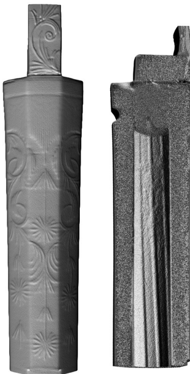
Il. 6. Trójwymiarowy model części dennej lufy (strzelba typu šišana, Turcja, XVIII/XIX wiek, nr inw. MNK V. 1462) uzyskany na podstawie tomogramów. Od lewej: widok zewnętrzny, następnie przekrój w płaszczyźnie stycznej przewodu lufy. Wyk. A. Tchórz
