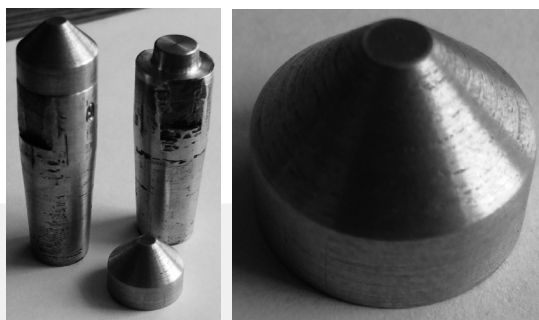
Rys. 6. Nasadkowe końcówki elektrod wykonane z kompozytu z tufem (badania własne)
