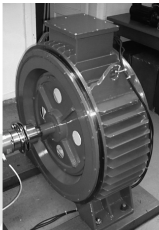
Rys. 8. Złożony generator przygotowany do badań
