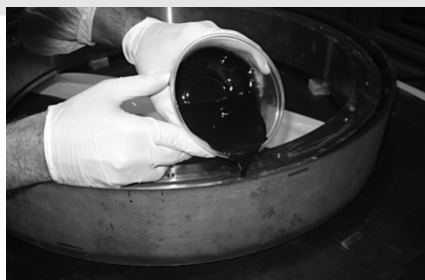
Rys. 7. Uszczelnianie magnesów żywicą
