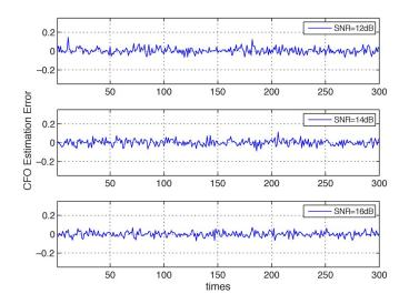
Fig. 1. CFO estimation error ( $\epsilon_0 \in (-1, 1), z \in [-14, 14], \text{QPSK}$ ).
