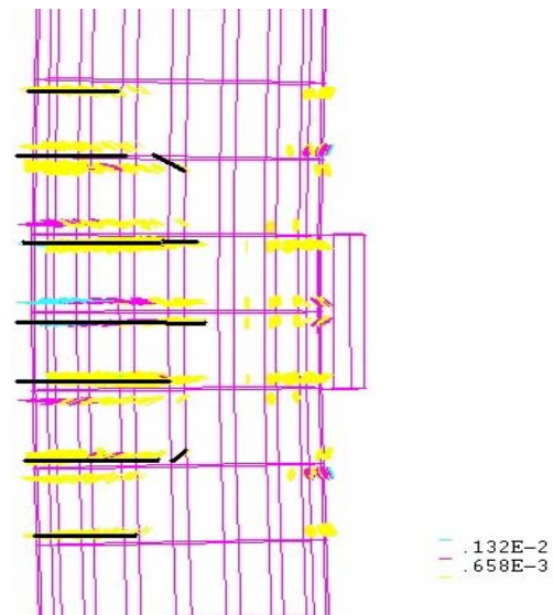
(d) Shear cracks at mid-height under 1250kips
