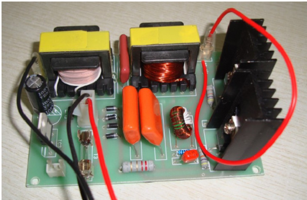
Figura 4. Fotografía de tarjeta de control YDE2-60W adquirida para las pruebas iniciales.
