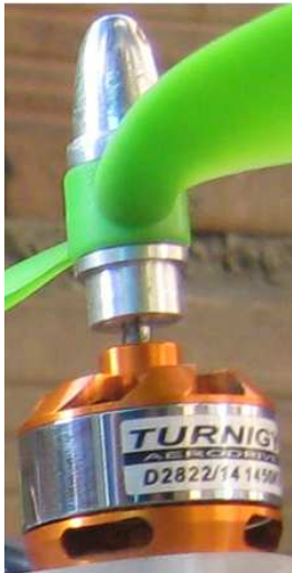
Figura 8. Motor D2822/14 Brushless Outrunner 1450 kV.
