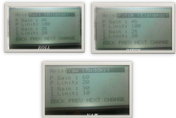
Figura 20. Eje de ROLL, PITCH y YAW valores por defecto. (Hobbyking, s.f.)
