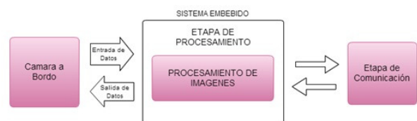
Figura 7. Diagrama general del procesamiento de imágenes a bordo.
