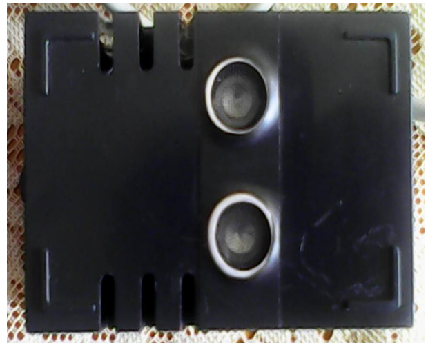
Figura 2. Encapsulado del sensor HC SR-04 en caja de acrílico.
