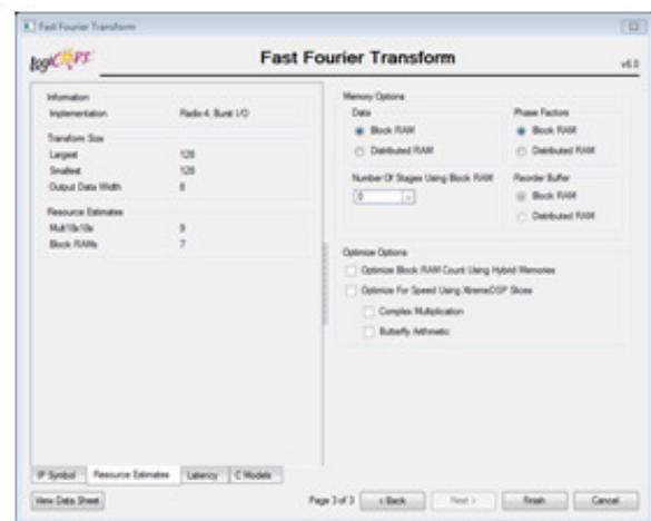
Figura 13. Configuración del bloque FFT paso 3.
