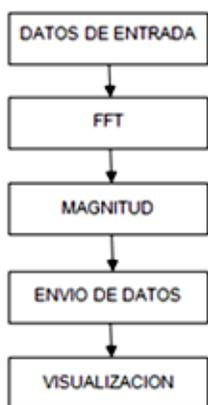
Figura 1. Diagrama de bloques del sistema.
