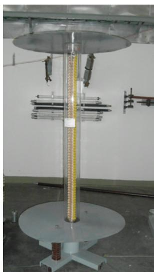
**Figura 2.** Divisor de tensión capacitivo amortiguado del LAT
