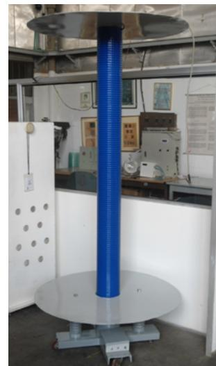
**Figura 14.** Divisor capacitivo amortiguado de 300 kV (versión final)
