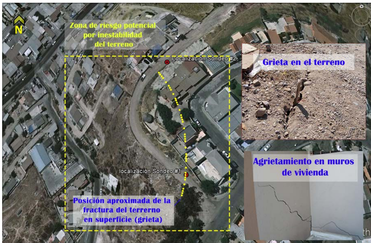
Figura 1. Zona de riesgo potencial por deslizamiento
