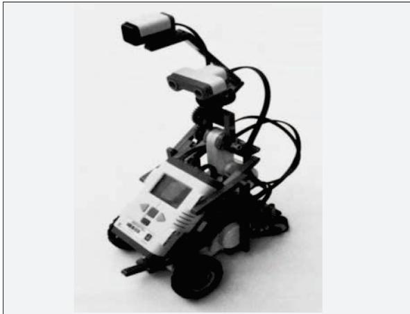
**Figura 1.**Plataforma móvil Tankbot.
