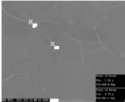
Fig. 9. Micrografía a 600X del recubrimiento Si/Ti: 10/90.
