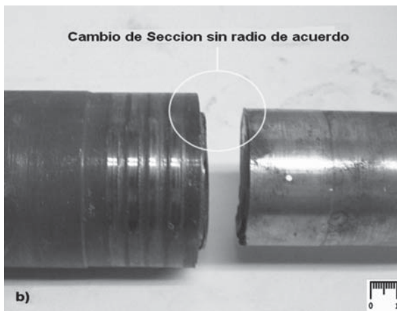
Figura 6. Fotografías en la zona de fractura. (a) Superficie de fractura; (b) cambio de sección en la zona de falla.
