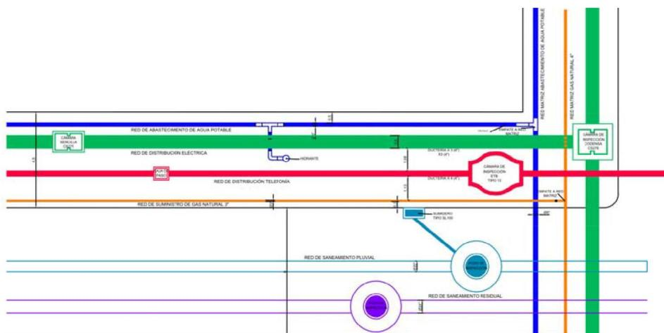
**Figura 1.** Esquema general de instalación de redes en el proyecto
