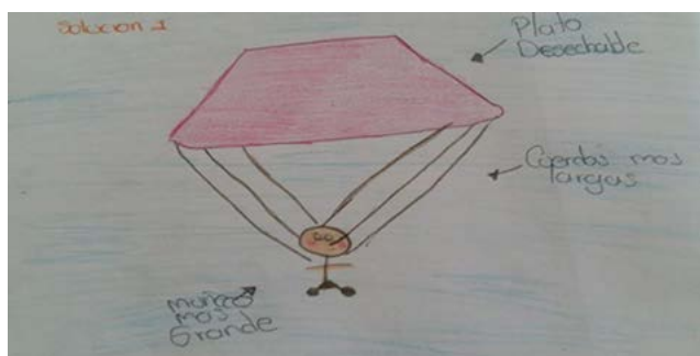
Figura 6. Dibujo de las mejoras hechas a un paracaídas, representa el reemplazo de la bolsa por un plato desechable, las cuerdas más largas y mayor peso que el inicial.
