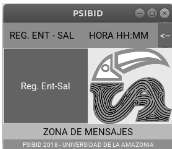
Figura 13. Interfaz de prueba del funcionamiento del PSIBID, en la que se realiza en manejo de Reg: registro huella en el sistema, Ent: entrada al espacio físico y Sal: salida.
