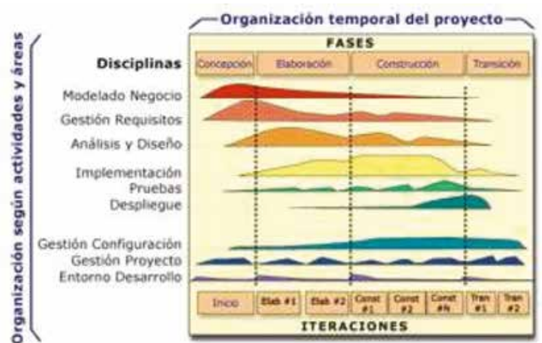
Figura 1. Proceso Unificado (UP), relación entre las fases del proyecto y las disciplinas técnicas que se abordan en cada una de las iteraciones
