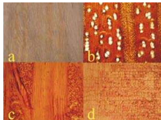
Figura 23. Myrsine coriacea (Sw.) R. Br. ex Roem. & Schult. a) Fotografía del plano tangencial de la Madera (Tamaño real). Fotomicrografías (Aumento 400X): b) Plano transversal, c) Plano tangencial, d) Plano radial.
