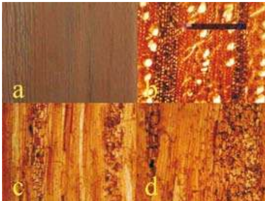
Figura 18. Hedyosmum bomplandianum Kunth. a) Fotografía del plano tangencial de la Madera (Tamaño real). Fotomicrografías (Aumento 400X): b) Plano transversal, c) Plano tangencial, d) Plano radial-tangencial.
