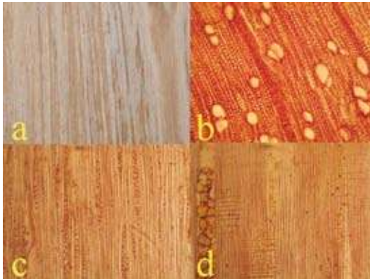
Figura 12. Clusia multiflora (Kunth). a) Fotografía del plano tangencial de la Madera (Tamaño real). Fotomicrografías (Aumento 400X): b) Plano transversal, c) Plano tangencial, d) Plano radial.
