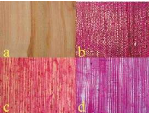
Figura 31. Podocarpus oleifolius D. Don ex Lamb. a) Fotografía del plano tangencial de la Madera (Tamaño real). Fotomicrografías (Aumento 400X): b) Plano transversal, c) Plano tangencial, d) Plano radial.
