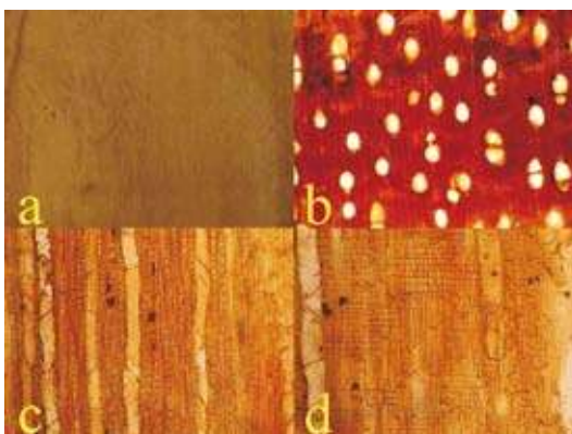
Figura 20. Miconia ferruginea (Desr.)DC. a) Fotografía del plano tangencial de la Madera (Tamaño real). Fotomicrografías (Aumento 400X): b) Plano transversal, c) Plano tangencial, d) Plano radial.
