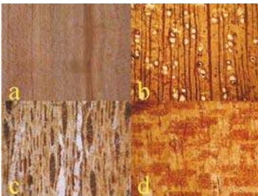
Figura 32. Prunus integrifolia (C. Presl) Walp. a) Fotografía del plano tangencial de la Madera (Tamaño real). Fotomicrografías (Aumento 400X): b) Plano transversal, c) Plano tangencial, d) Plano radial.
