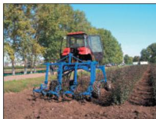
Рис. 13. Высоклиренсная платформа ВП-1,5 с трактором МТЗ-320
