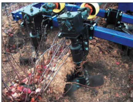
Рис. 4. Машина для раскрытия корневой системы отводков UKM-PK
