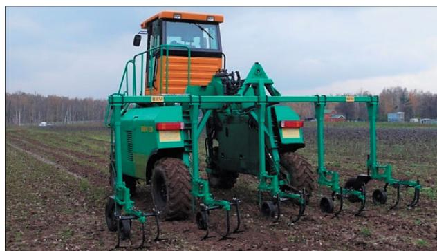
Рис. 11. Широкозахватный пропашной высококлиренсный культиватор
