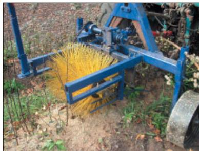
Рис. 5. Машина для ошмыгивания листьев с отводков UKM-OSH
