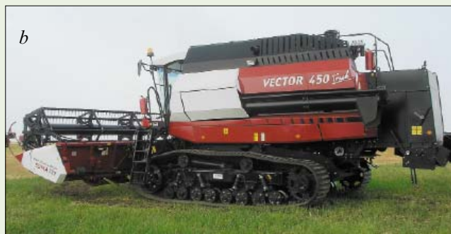
Рис. 1. Самоходные зерноуборочные комбайны на гусеничных тележках с резиноармированными гусеницами:
