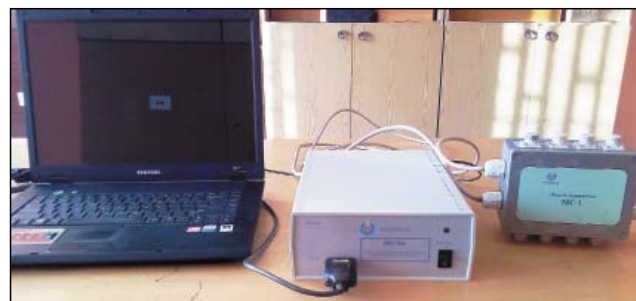
Рис. 1. Общий вид измерительной системы ИП 264 подключенной к ноутбуку и модулю согласования МС-1
