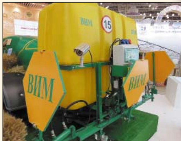
Рис. 2. Универсальный технологический адаптер для МИО растений, представленный на выставке «Золотая осень – 2016»
