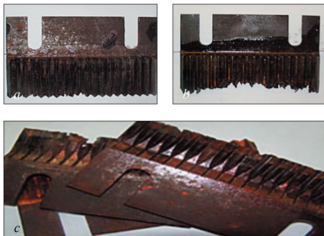
Рис. 3. Дефектное состояние режущих граней ножей: а – изношенная режущая кромка; б – разрушенная режущая кромка; с – деформированные с локальными поломками режущие грани
