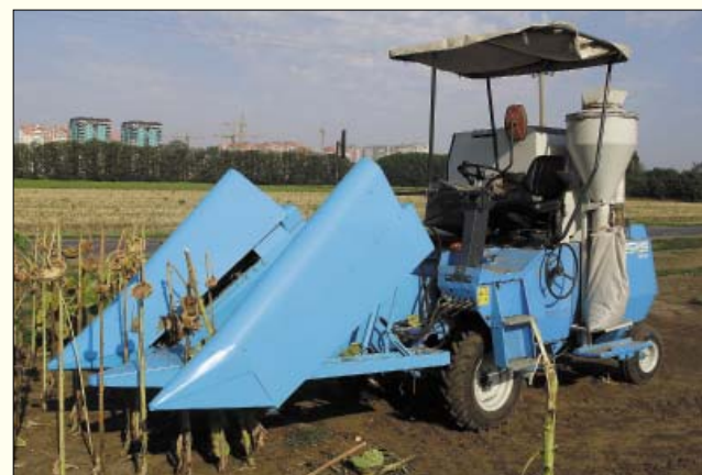
Рис. 2. Селекционный комбайн Classic с новой жаткой для уборки подсолнечника
