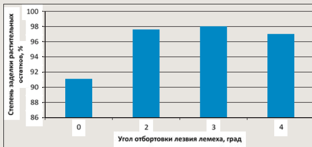
Рис. 3. Влияние угла отбортовки лезвия лемеха на степень заделки растительных остатков
