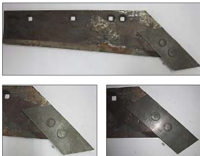
Рис. 3. Общий вид лемеха и фрагменты его остова с различными вариантами долот
