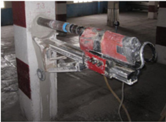
Figura 3. Detalles del proceso de análisis de ultrasonidos (superior) y momento de extracción de una probeta testigo (inferior)
