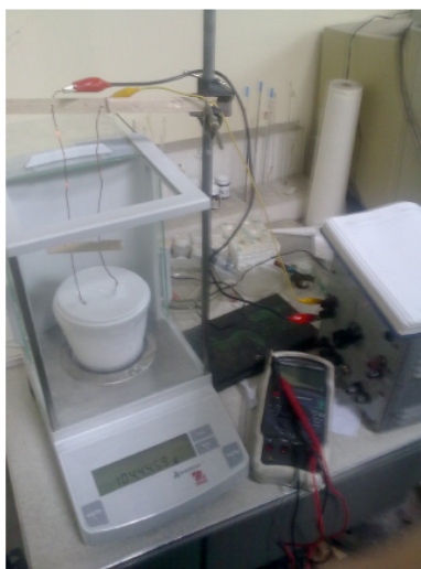
Fig. 4. Montaje experimental utilizado en la medición del Calor latente de vaporización del N_2
