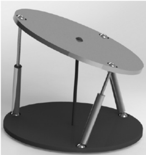
Figura 5: Robot paralelo 3 -UPS - 1S [44].
